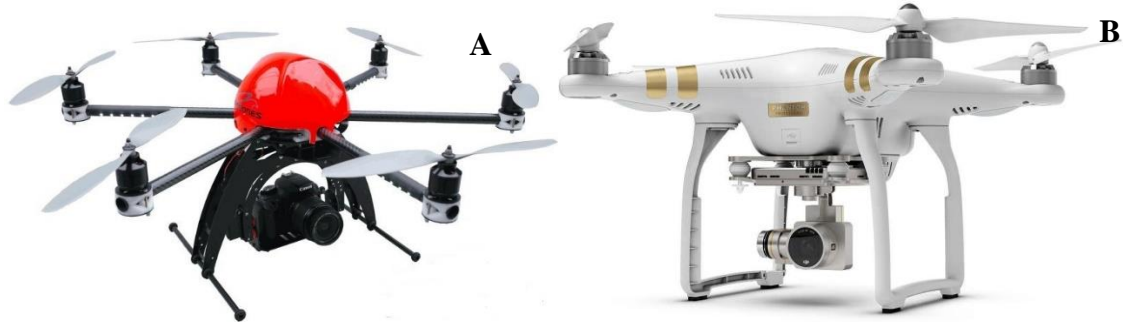
Figura 2 - Veículos Aéreos Não Tripulados (VANTS) de asa rotativa, modelos SD6 SPYDER XL skydrones (A) e modelo Dji Phantom 4 (B).
